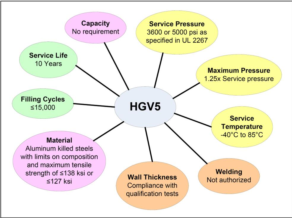
Figure 7 – HGV5 Web Diagram
